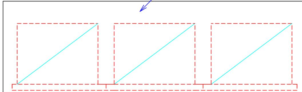
ステンレス引出し SUS430 No.4仕上げ t=0.8mm
