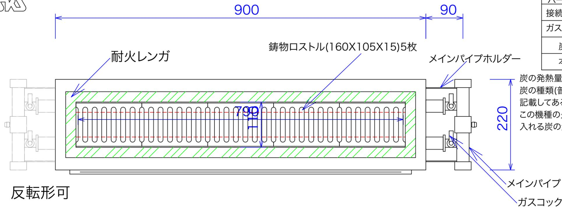
炭の発熱量は1Kgあたり7,000Kcal(8.1Kw)から8,000(9.3Kw)です。炭の種類(普通の木炭、備長炭、高級備長炭等)によって巾があります。記載してある炭参考発熱量はC-600の火床に1Kgの炭を入れるとしてこの機種種の火床容量と比例計算したものです。入れる炭の量、炭の起こり加減等で実際の発熱量とは異なります。
