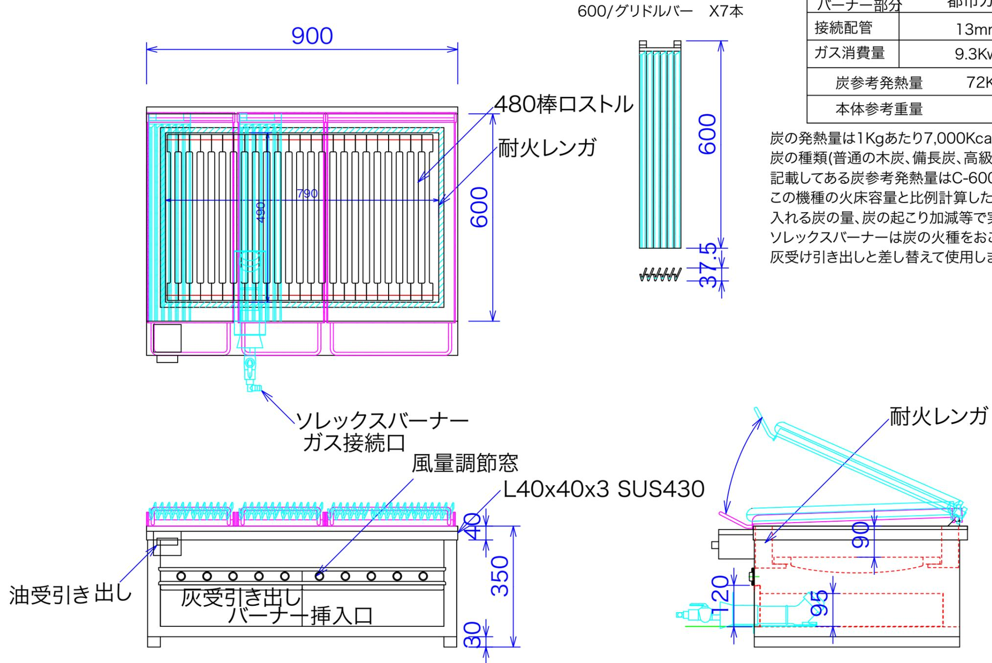
炭の発熱量は1Kgあたり7,000Kcal(8.1Kw)から8,000(9.3Kw)です。炭の種類(普通の木炭、備長炭、高級備長炭等)によって巾があります。記載してある炭参考発熱量はC-600の火床に1Kgの炭を入れるとしてこの機種種の火床容量と比例計算したものです。入れる炭の量、炭の起こり加減等で実際の発熱量とは異なります。ソレックスバーナーは炭の火種をおこすためのものです。灰受け引き出しと差し替えて使用します。
